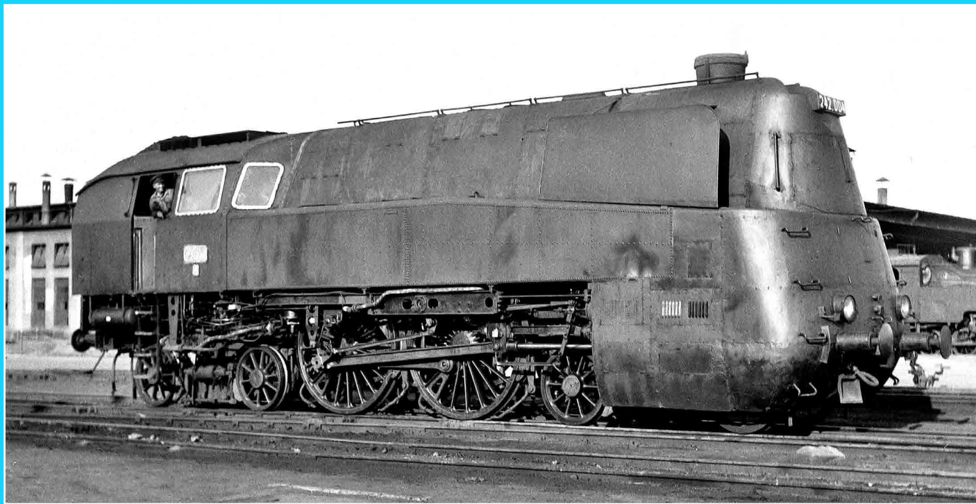
9. ábra A 242,004 pályaszámú, két kapcsolt kerékpárú, túlhevített gőzű, ikergépezetű (2'B2'-h2t) gyorsvonati mozdony. A Molnár Tibor gyűjteményéből származó fotót Miskolcon készítette Mohay László. A magyar gőzmozdonyos sebességi rekordot is e típus tartja. Az engedélyezett sebesség a sorozatnál 120 km/h volt. Összesen négy mozdonyt gyártottak e járművekből (1936–1940).
