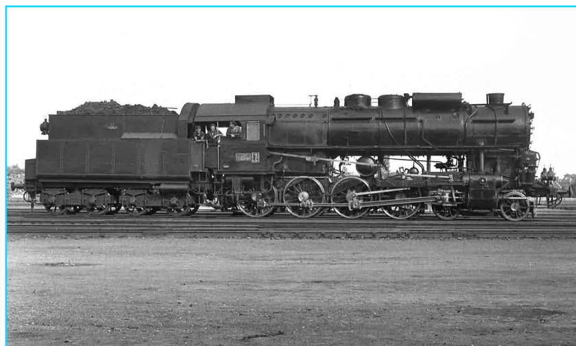
2. ábra 424,007 pályaszámú mozdony, 2'D–h2, Miskolcon. Mohay László felvétele. Molnár Tibor József gyűjteményéből. A jármű 1924. augusztus 11-én lett üzembe helyezve. A Göd és Vác között e napon végrehajtott műtanrendőri próbán 108 km/h sebességet ért el.
