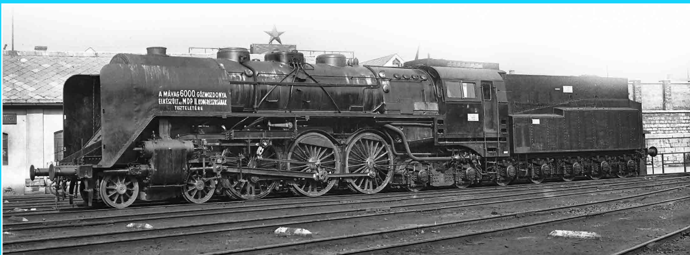
10. ábra 303,002 pályaszámú gyorsvonati mozdony. Pollák Róbert felvétele. Molnár Tibor József gyűjteményéből. A sorozatból mindössze 2 mozdonyt gyártottak. A 2'C2' tengelyelrendezésű járművek 1951-ben kerültek üzembe. Engedélyezett sebességük 120 km/h volt.
