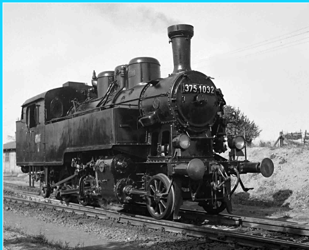
12. ábra A 375,1032 pályaszámú mozdony a MÁVAG utoljára gyártott gőzmozdonya. A mozdonyról készült fénykép Linzbauer Tamás gyűjteményéből származik. Az 1'C1'–2ht nagyon jól bevált, a 60 km/h engedélyezett sebességű mozdonyból 1907 és 1959 között 529-et gyártottak a MÁV megrendelésére.
