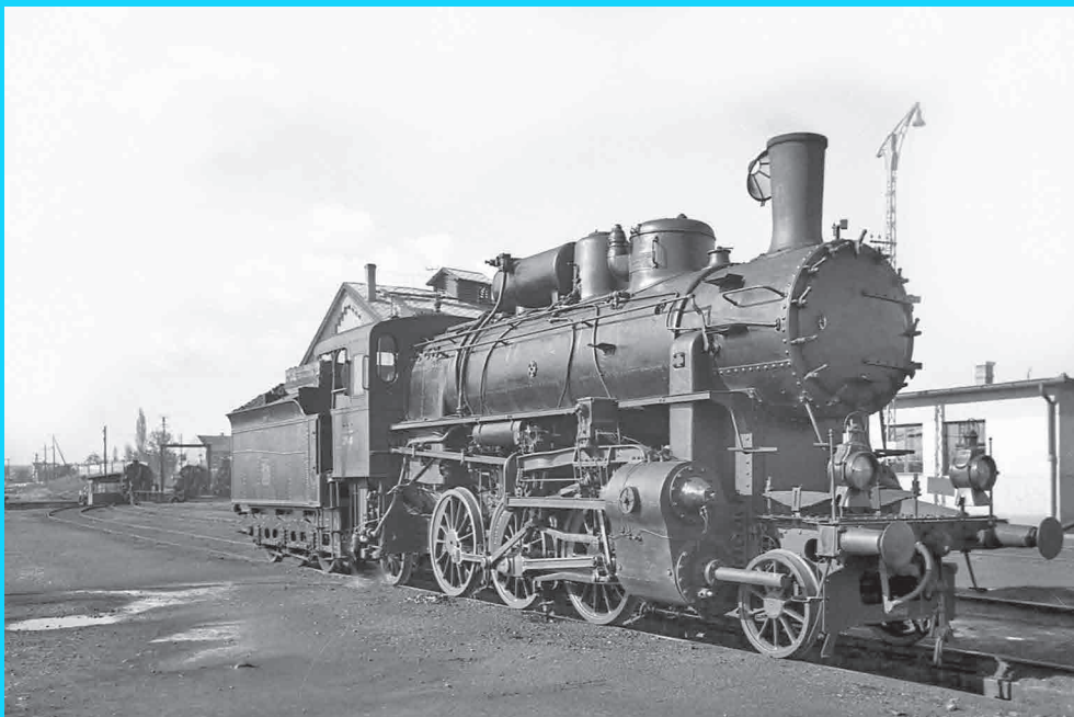
6. ábra A 324,810 pályaszámú, síktűzszekrényes, túlhevített gőzű, ikergépezetű, 1922-ben gyártott gőzmozdonyt Pollák Róbert fényképezte. Jelen felvétel Molnár Tibor József gyűjteményéből származik. A 75 km/h engedélyezett sebességű 324-es típus a MÁV legnagyobb számosságú sorozata. A számos variánsban, 1909 és 1942 között gyártott mozdonyból 895 a MÁV, 10 pedig a Szlovák Vasút részére készült. A Brotán-rendszerű, vízcsöves álló-kazánú 324-es volt az első tervezetű, 1'D tengelyelrendezésű, ikergépezetű, tehervonatok továbbítására szánt 424-es típus alapja.
