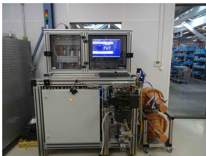
KE1A3,8SL típusú kormány szelep próbapadi mérése / End of line test of a KE1A3,8SL distributor valve / Prüfstandskontrolle eines KE1A3,8SL Steuerventils
