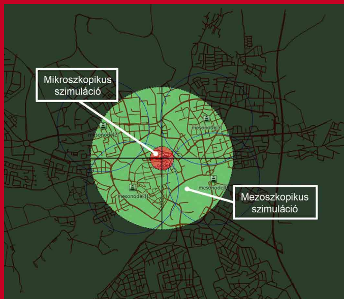
A V2X-kommunikáció mezozkopikus szimulációja SUMO-VEINS-OMNeT++ szoftverrendszerrel megvalósítva
