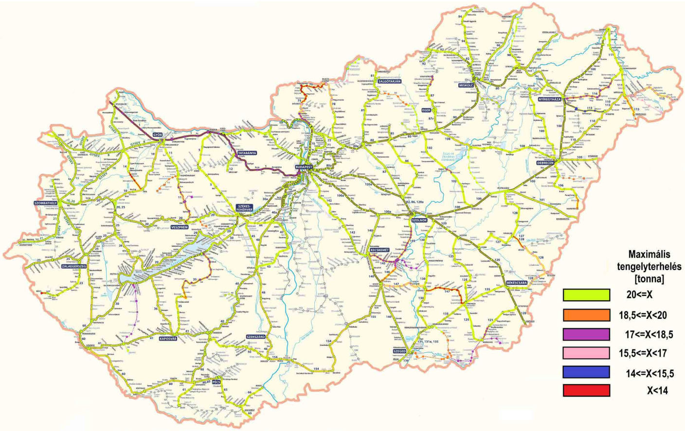
1. ábra: A magyarországi vasútvonalakon sebességkorlátozás nélkül engedélyezett maximális tengelyterhelések. A vonalak rajzolata utal a személyforgalom jellegére, valamint a pálya villamosított ill. kétvágányú voltára. [7]
