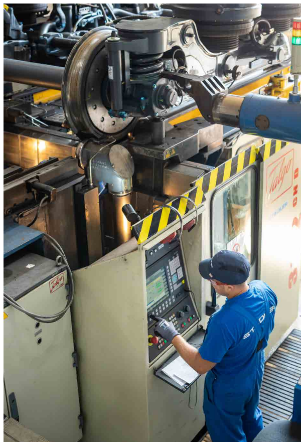
Kerékpár-esztergálás a Stadler Magyarország Vasúti Karbantartó Kft. pusztaszabolcsi telephelyén
