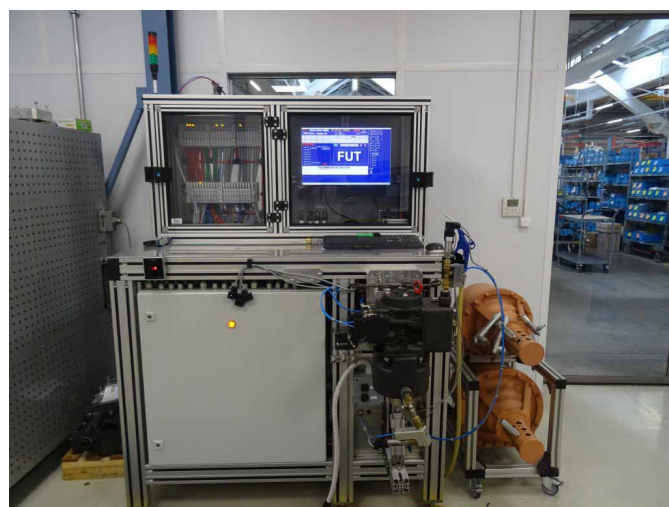
KE1A3,8SL típusú kormány szelep próbapadi mérése / End of line test of a KE1A3,8SL distributor valve / Prüfstandskontrolle eines KE1A3,8SL Steuerventils
