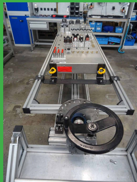
Fékpanel főösszeszerelése / Main assembly of a brake panel / Hauptmontage eines Bremsstafels
